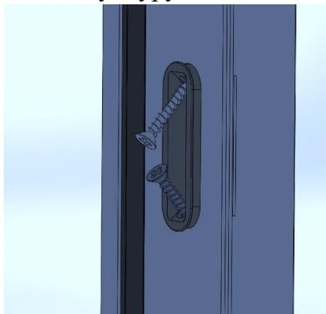
Рис 5. Установка ответной планки в стойку коробки
